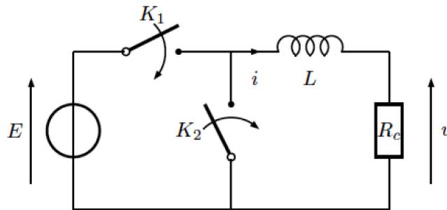
Figure 3 - Modélisation du hacheur
