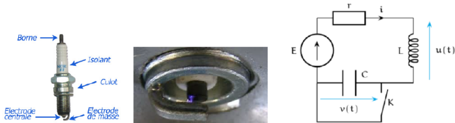
Figure 1 - Bougie d'allumage. Modèle électrique utilisé.
