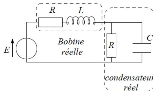
**20** - Déterminer l'équation différentielle vérifiée par la tension  $u(t)$  aux bornes du condensateur lorsque le circuit est branché, à  $t = 0$ , sur un générateur de tension  $E$ . Mettre cette équation sous forme canonique et identifier la pulsation propre et le facteur de qualité du système.
